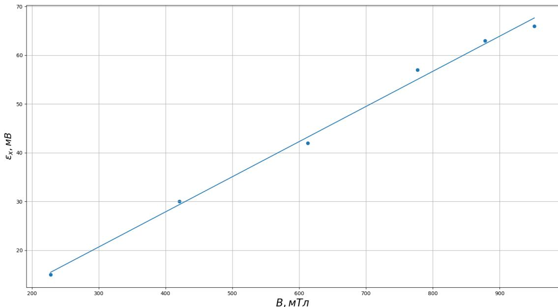
Рисунок 6. График зависимости ЭДС Холла  $\varepsilon_x$  в образце из цинка от магнитной индукции  $B$ , при разных значениях постоянного тока через образец, при фиксированном токе через электромагнит  $I_M = 1 A$ .
