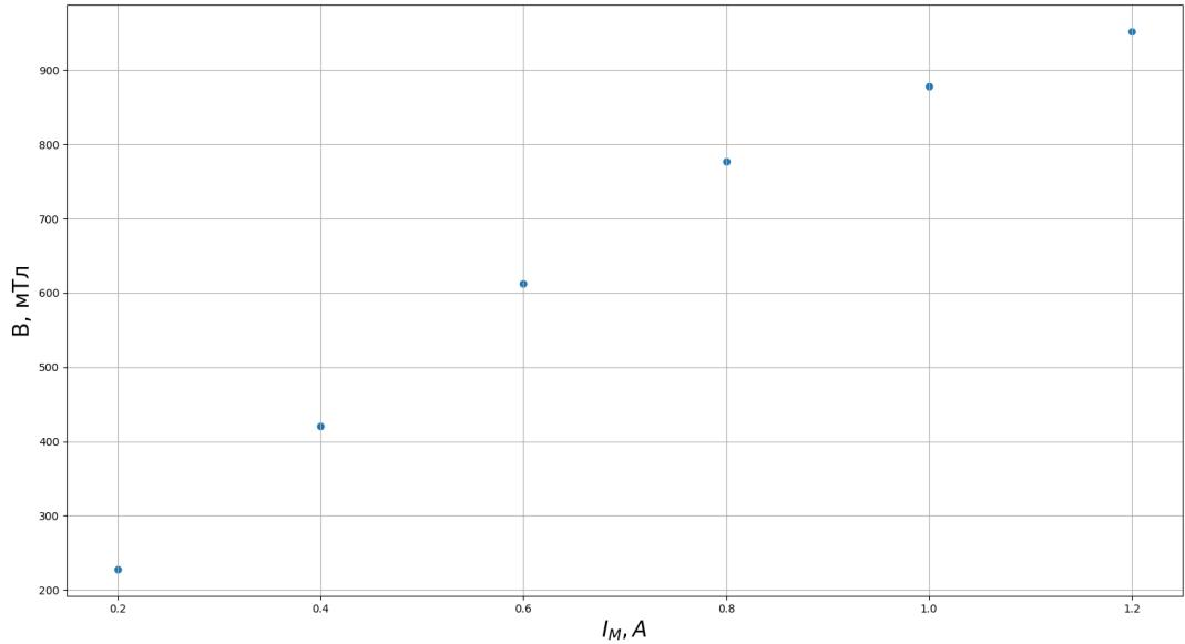
Рисунок 3. Зависимость магнитной индукции  $B$  от тока  $I_M$  через магнит, измеренная с помощью измерителя магнитной индукции Ш1-10. Ток через электромагнит изменялся в интервале 0,2–1,2 A.
