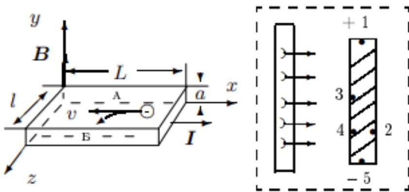
Рисунок 1. Металлическая пластинка с током в магнитном поле.
