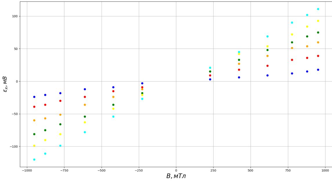
Рисунок 4. График зависимости ЭДС Холла  $\varepsilon_x$  в образце из меди от магнитной индукции  $B$ , при разных значениях постоянного тока через образец. Ток через образец изменялся в интервале 0,2–1,2 A. с шагом 0,2 A.
