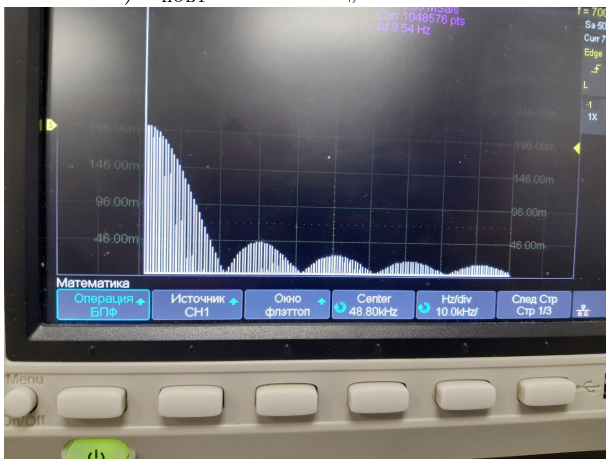
с) \nu_{\text{повт}} = 700 \text{ Гц}, \tau = 50 \text{ мкс}
