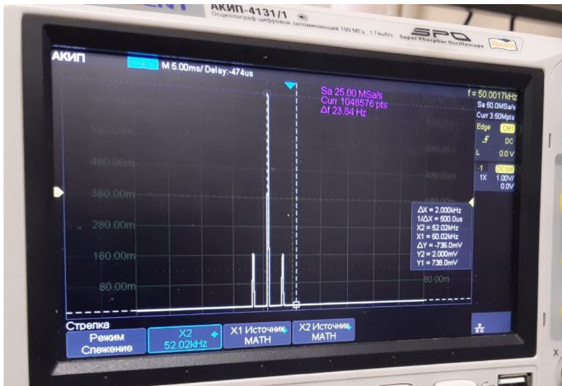
Рис. 7: Спектр сигнала, модулированного по амплитуде, при частоте несущей \nu_0 = 50 кГц, частоте модуляции \nu_{\text{мод}} = 2 кГц
