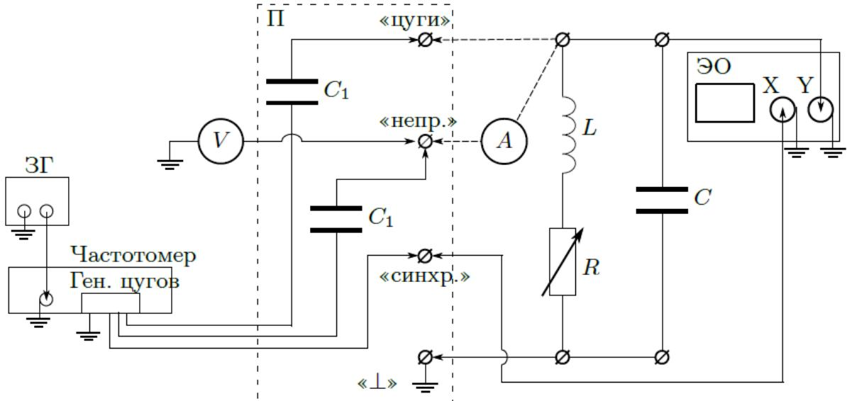
Рис. 2: Схема экспериментальная установка для исследования вынужденных колебаний: ЗГ - звуковой генератор Г3-112, ген. цугов - генератор цугов ЧЗ-57, В - вольтметр В3-38, R - магазин сопротивлений МСР-60, L - магазин индуктивностей Р567, ЭО - осциллограф ГОС-620, П - панель
