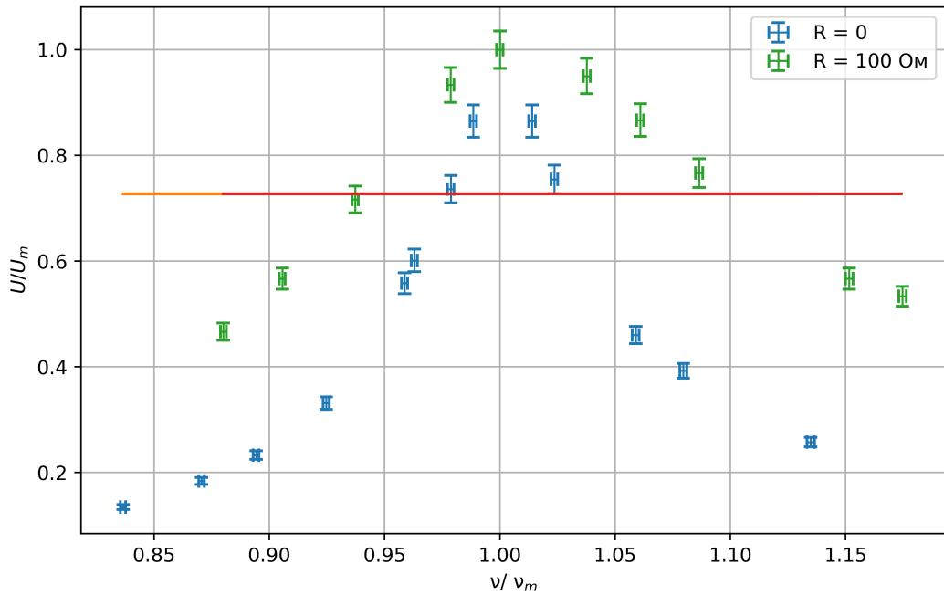
Рис. 3: Резонансная кривая в относительных единицах:  $U/U_m$  - отношение амплитуды к резонансному значению,  $\nu/\nu_m$  - отношение частоты к резонансному значению, для параллельного контура  $C = 0.1 \text{ мкФ}$ ,  $L = 100 \text{ мГн}$
