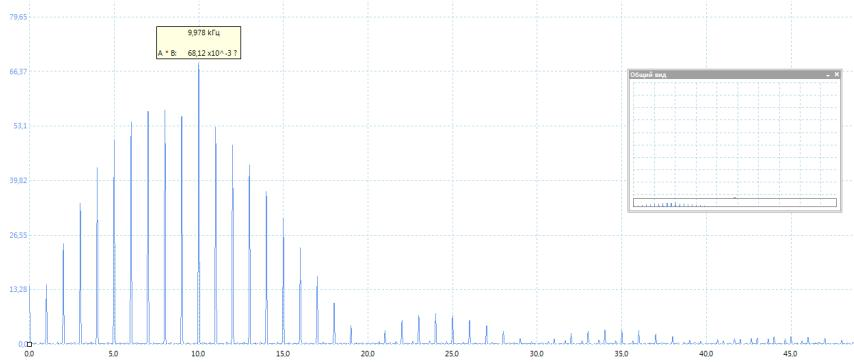
Рисунок 2.7 — Разложение в спектр периодической последовательности
