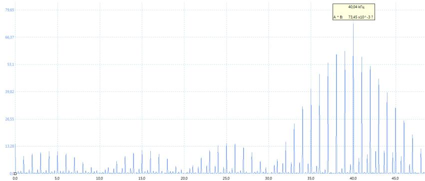
Рисунок 2.9 — Разложение в спектр периодической последовательности
