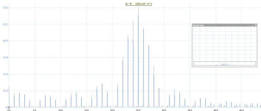
Рисунок 2.8 — Разложение в спектр периодической последовательности
